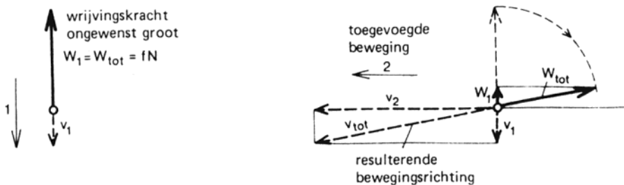
Figuur 4.6 Effect van het toevoegen van een extra beweging op de richting van de wrijvingskracht W_{tot} .
